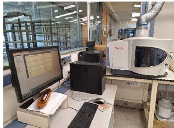
Figura 8: Espectrómetro de Emisión ICP-OES Modelor ICAP 7400 DUO
