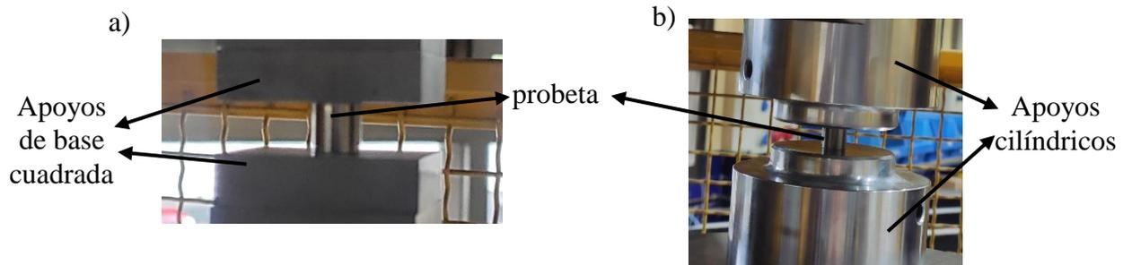
**Figura 1.-** a) Disposición del ensayo de compresión con los apoyos cuadrados facilitados por el petionario; b) Disposición del ensayo de compresión realizado sobre las bases cilíndricas disponibles en el CENIM.
