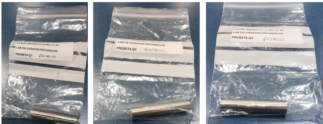
Figura A.3. Detalle de probetas mecanizadas por el Laboratorio de Fabricación mecánica del CENIM identificadas Q1, Q2 y Q3.
